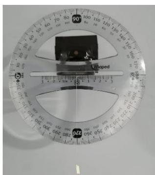
Fig. 4.-Transportador incorporado a péndulo simple para medir la amplitud inicial.
